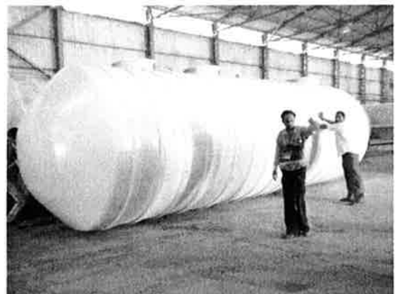
写真-4 浄化槽NBF-25(処理量25m 3 /日タイプで直 径2.43m×長さ8m)
